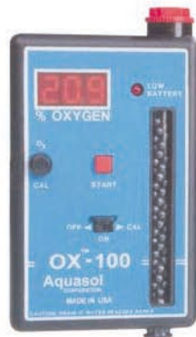
MEDIDOR DE GAS
